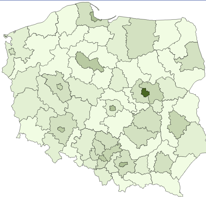
Rys. 4-9 Zapotrzebowanie na energię elektryczną pojazdów elektrycznych w 2032 roku, łącznie: 2,71 TWh
