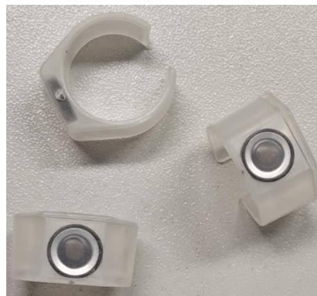
Dawkomierze UD-807 do pomiaru indywidualnego równoważnika dawki Hp(0.07) – „pierścionki”.
