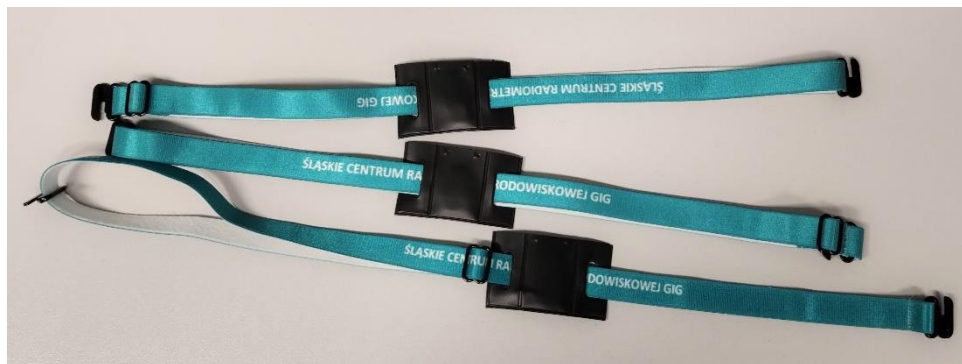
Dawkomierze UD-807 do pomiaru indywidualnego równoważnika dawki Hp(3) – dawka na oczy.
