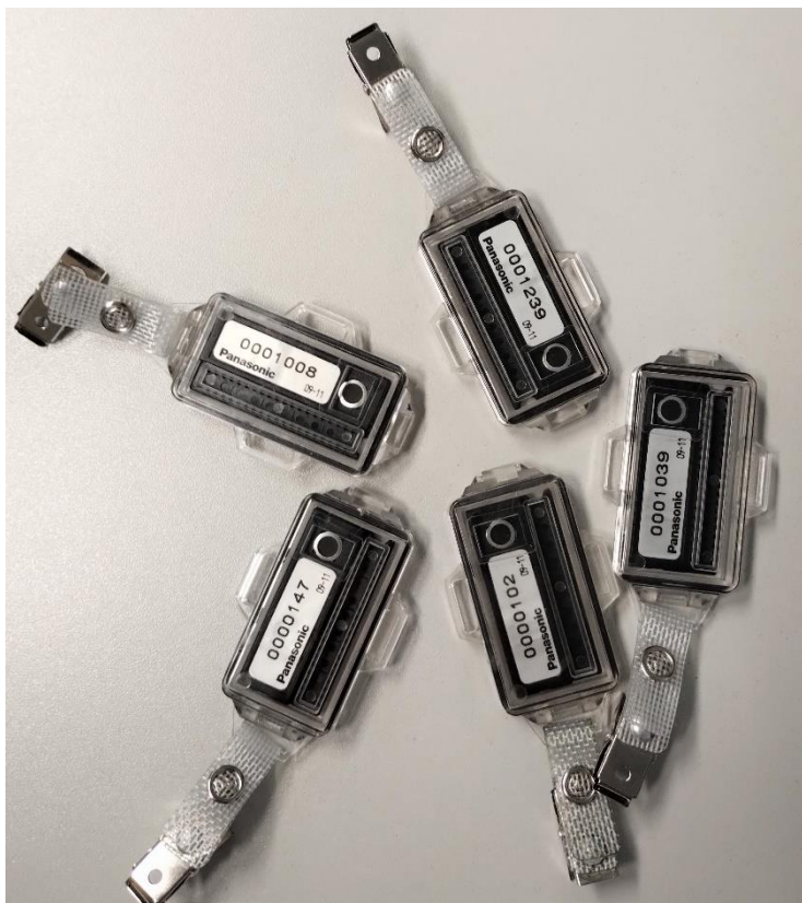
Dawkomierze UD-802 do pomiaru indywidualnego równoważnika dawki Hp(10).
