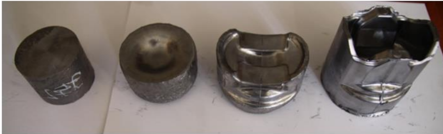
Wstępniak i odkuwki po kolejnych operacjach kucia z ołowiu
